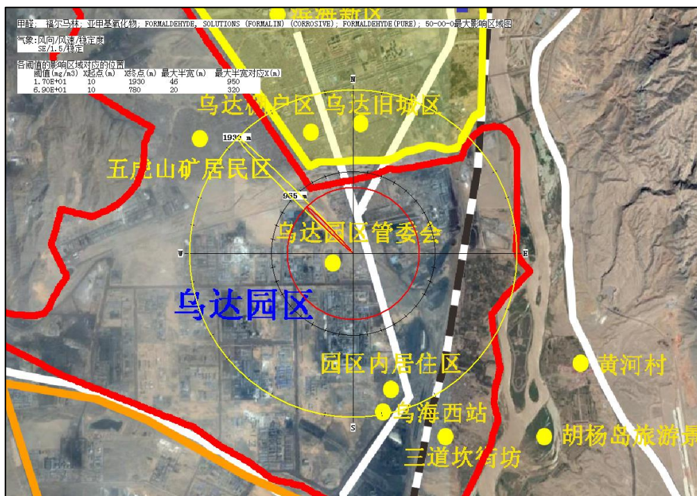
图 10.3-34 甲醛达到不同毒性终点浓度的最大影响区域图（最常见气象条件） （甲醛管道泄漏）
