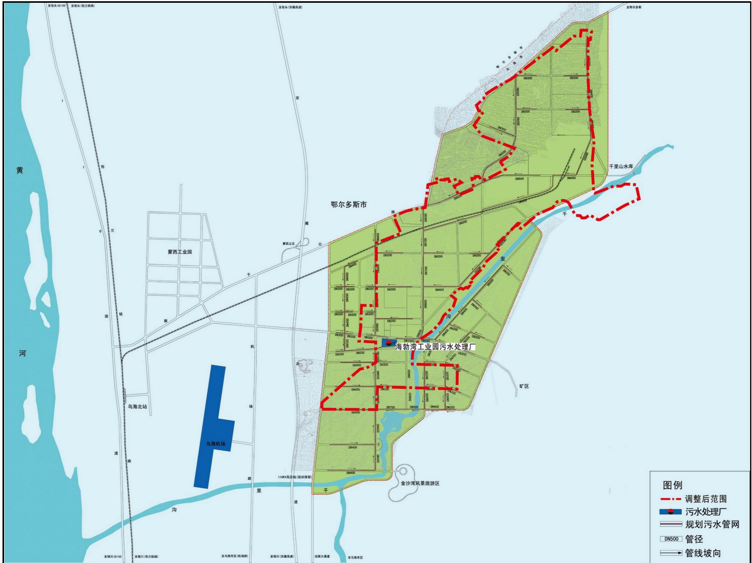
附图 2-3 污水管网工程规划
