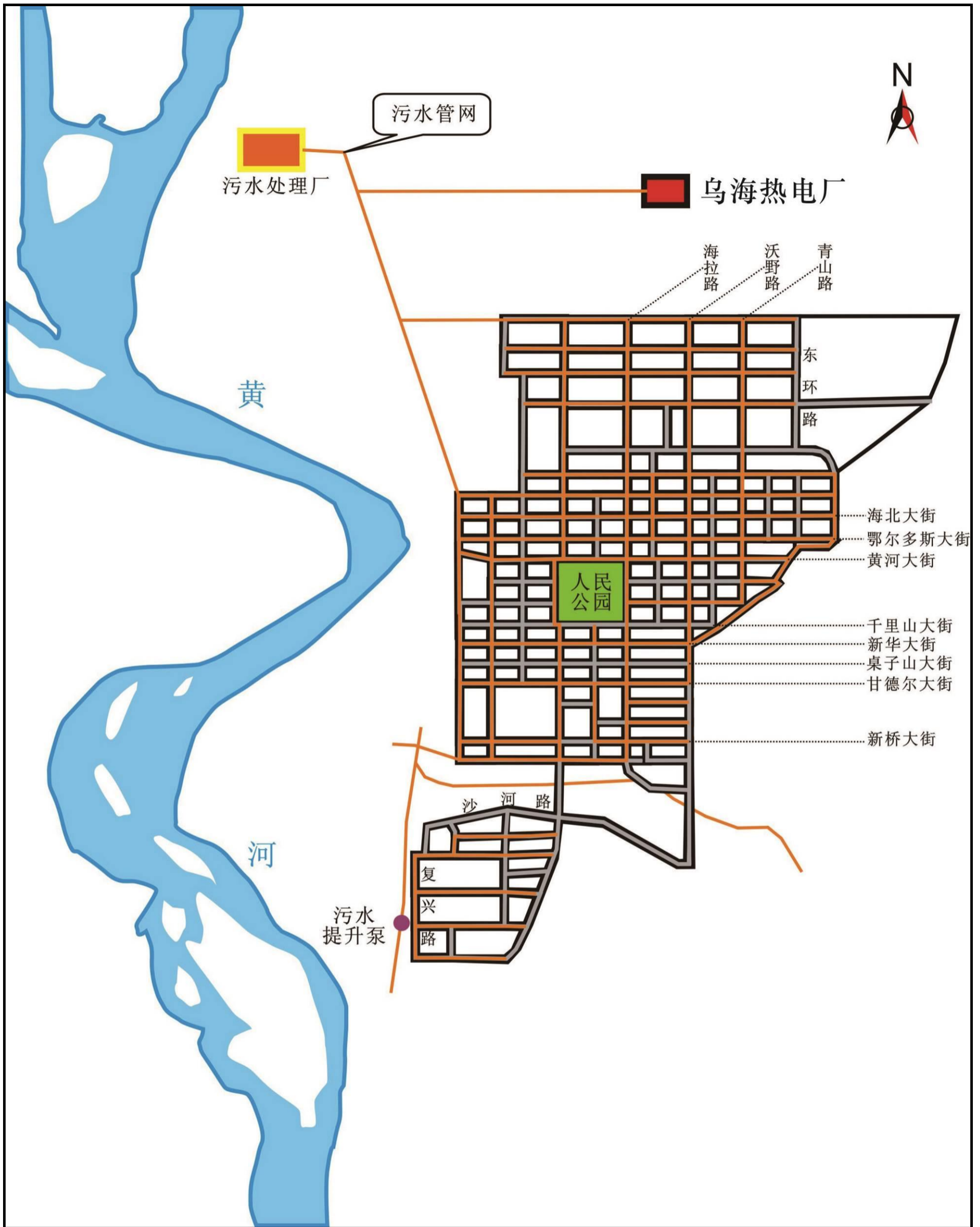
附图 3-1 乌海市海勃湾区污水处理厂再生水取水水源论证范围
